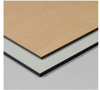
El laminado compacto núcleo negro de EGGER es un laminado de alta presión en conformidad con la norma EN 438-4, con un núcleo negro a base de resinas termoendurecibles. Los laminados compactos están elaborados con varias capas de papel prensadas entre sí, con hojas de papel decorativo impregnadas de resina melamínica en la superficie y varias hojas de papel impregnadas en resina fenólica en el núcleo.
