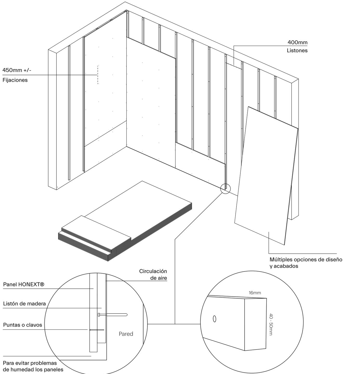
Para evitar problemas de humedad los paneles no deben instalarse en contacto con el suelo dejando +/- 15mm
