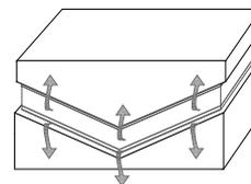
3. Dé forma y deje enfriar en el molde hasta que la temperatura del componente sea inferior a 70° C.
