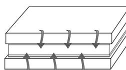
2. Caliente y presione el panel para que su interior llegue a los 95° C. (La temperatura de la prensa caliente suele ser 110 – 150° C).
